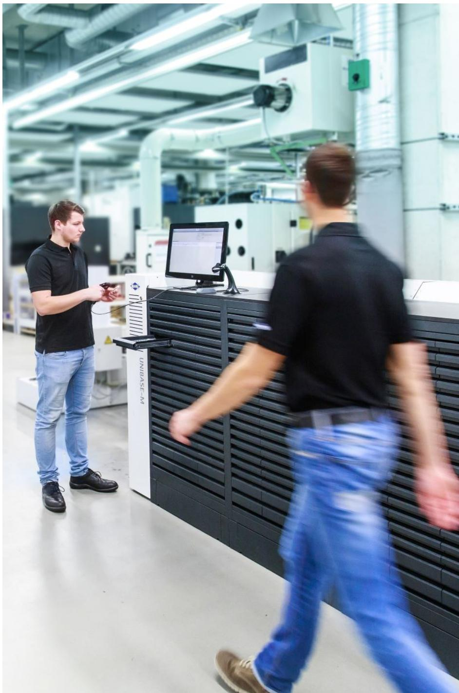
Ein zentrales Element des Tool-Managements ist das Werkzeugausgabesystem (Bild: Mapal).
