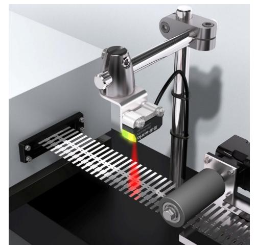
Eine Reflexionslichtschranke überwacht Bandmaterial bei der Zuführung, zum Beispiel gestanzte elektrische Kontakte (Bild: di-soric).
