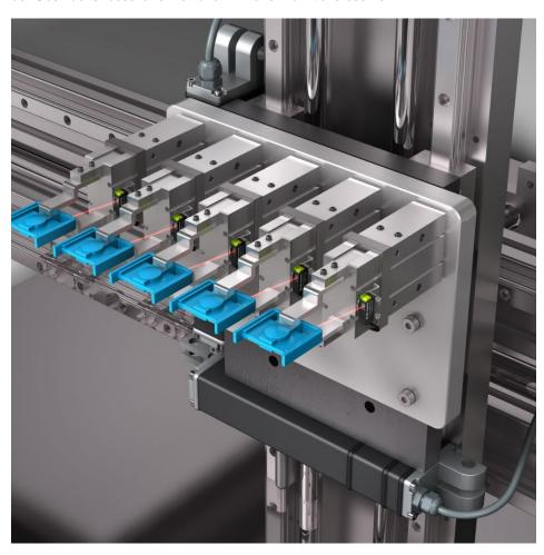
Arbeiten auch unter beengten Platzverhältnissen zuverlässig: Reflexionstaster mit Hintergrundausblendung kontrollieren Anwesenheit und Lage von Spritzgussteilen in Greifern (Bild: di-soric).
