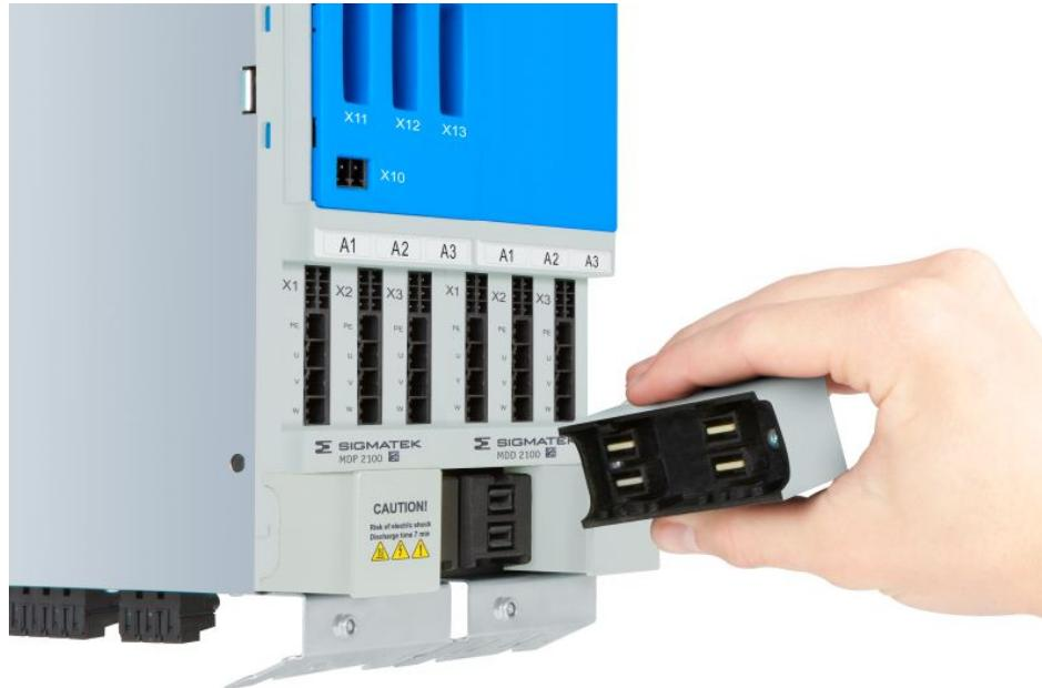
Eine Erweiterung des Multiachs-Verbundes kann schnell und werkzeuglos mittels DCB und BCB erfolgen (Bild: Sigmatek).
