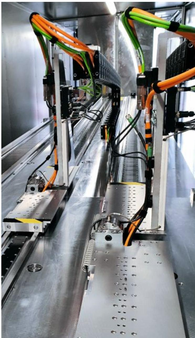
Die Qualität »made in Germany« beinhaltet auch umfangreiche Tests aller auszuliefernden Linearmotoren auf einem eigens dafür eingerichteten Prüfstand (Bild: Beckhoff).
