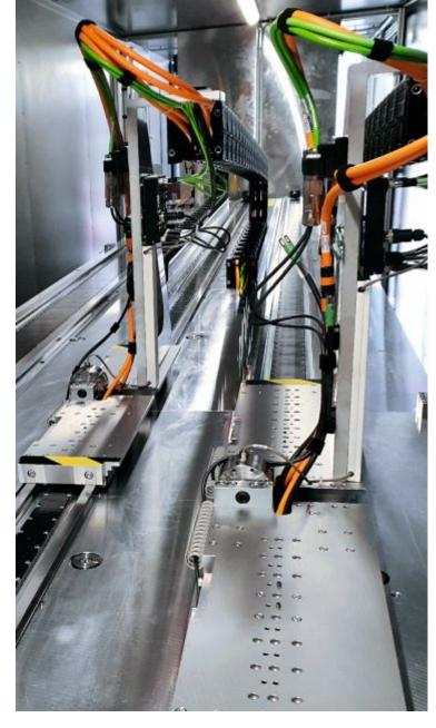
Die Qualität »made in Germany« beinhaltet auch umfangreiche Tests aller auszuliefernden Linearmotoren auf einem eigens dafür eingerichteten Prüfstand (Bild: Beckhoff).
