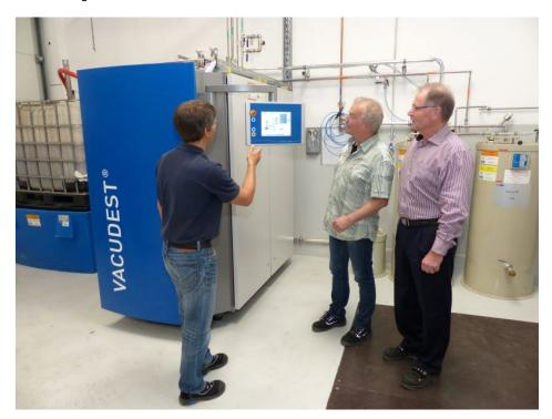
Bei der Vakuumdestillation ist der aufsteigende Wasserdampf nahezu frei von Verunreinigungen, 99 Prozent des Prozesswassers können in den Produktionsprozess zurückgeführt werden. Das Bild zeigt die Projektverantwortlichen vor der neuen Anlage (Bild: Jumo).
