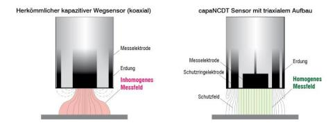
Vergleich koaxiales und triaxiales Messprinzip (Bild: Micro-Epsilon).
