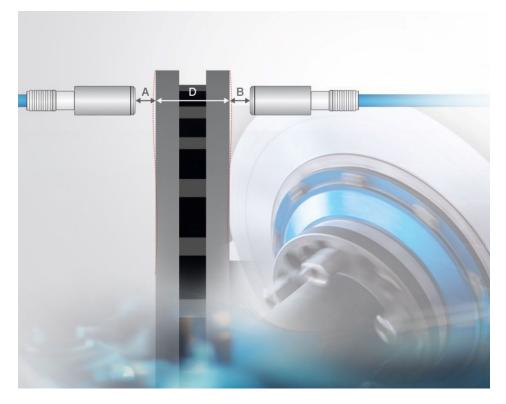
Temperaturstabile und robuste Sensoren kommen unter anderem bei der berührungslosen Erfassung der Disc Thickness Variation von Bremsscheiben zum Einsatz (Bild: Micro-Epsilon).
