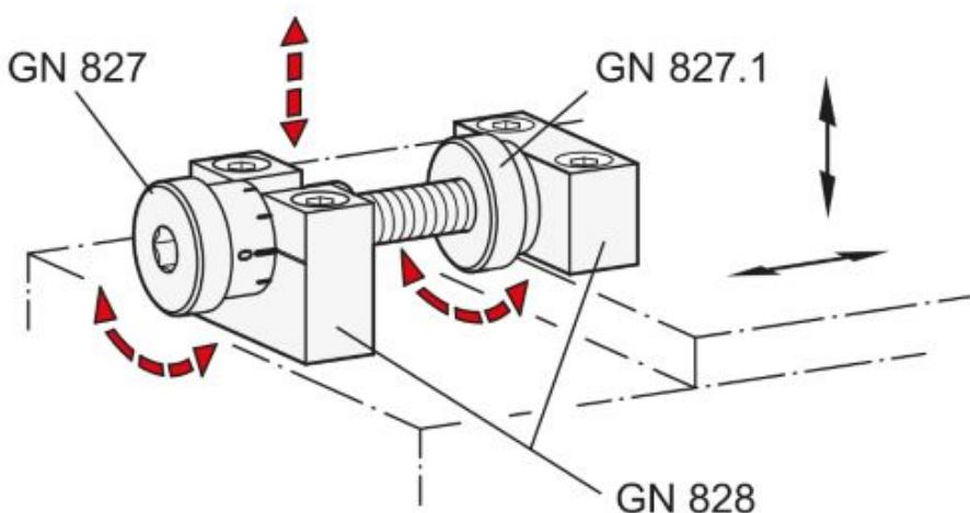
Für das einfache und sichere Verstellen sowie für einen schnellen Wechsel von Vorrichtungen oder Werkzeugen wurden die Edelstahlstellschrauben inklusive Verstellskala entwickelt (Bild: Ganter).
