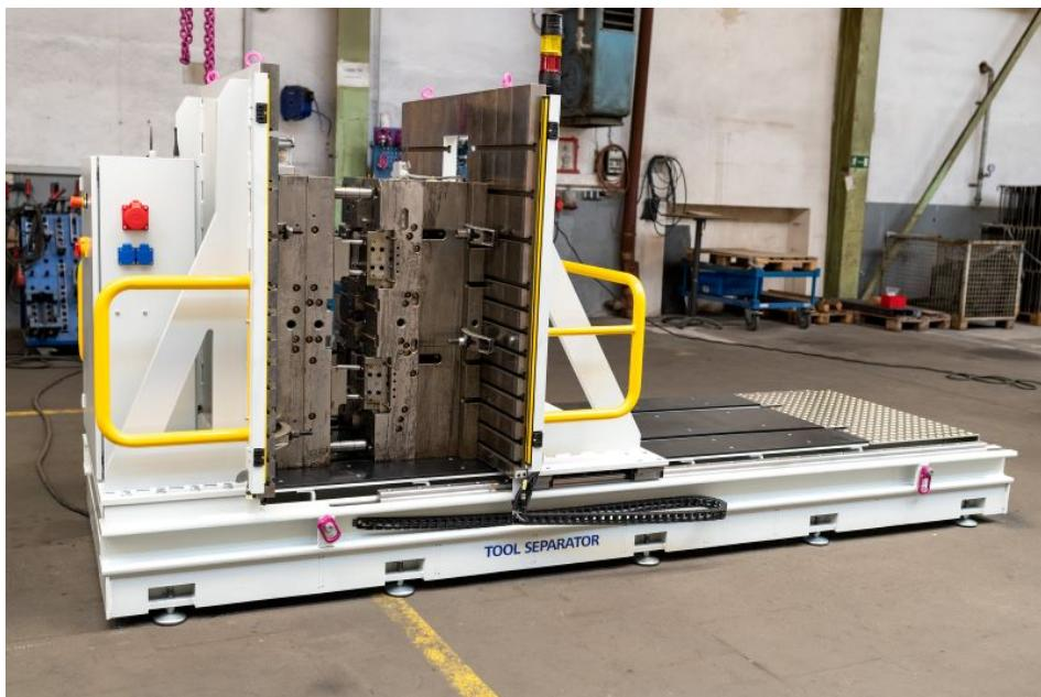
Prozess- und Kostenoptimierung: Mit dem neuen Werkzeugöffner sind auch schwere Werkzeuge schnell geöffnet (Bild: RUD).
