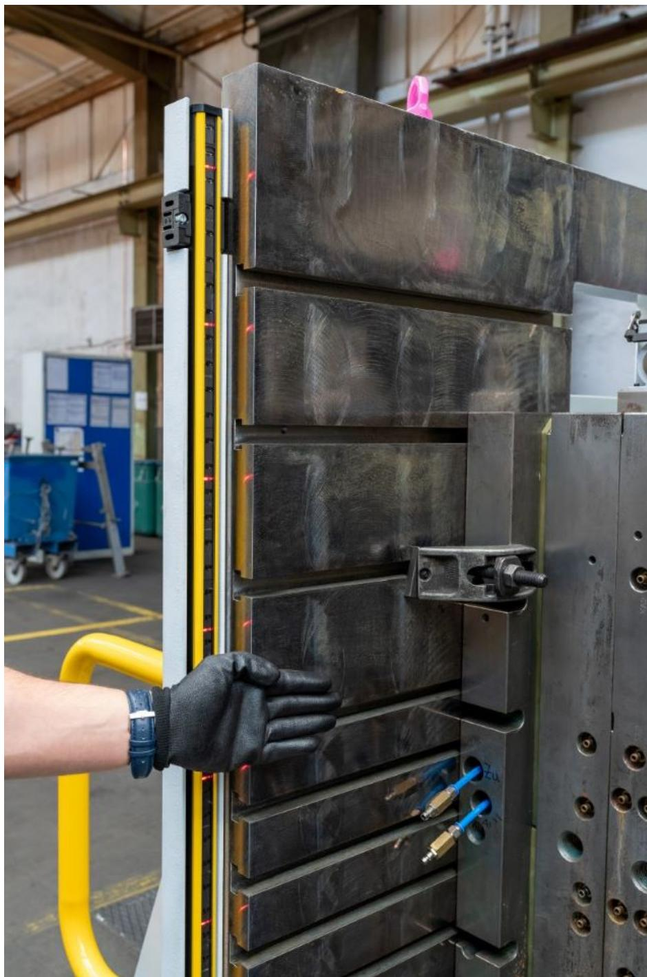
Der Sicherheitslichtvorhang schützt das Bedienpersonal am oder in der Nähe des Werkzeugwechslers »Tecdos TS« (Bild: RUD).
