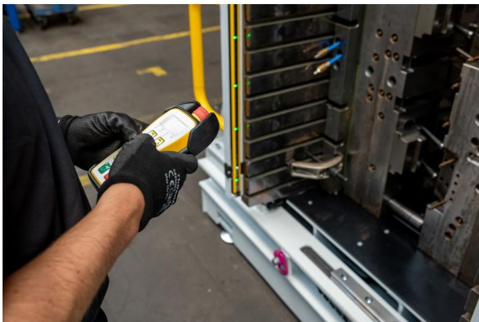
Ein Plus an Arbeitssicherheit und Ergonomie: Über Bediengeräte per Funksteuerung lässt sich der Werkzeugöffner bequem und sicher bedienen (Bild: RUD).
