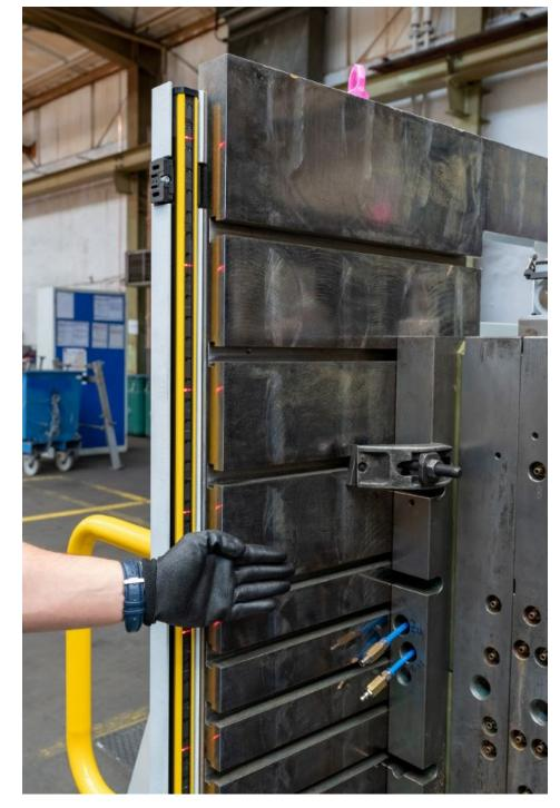
Der Sicherheitslichtvorhang schützt das Bedienpersonal am oder in der Nähe des Werkzeugwechslers »Tecdos TS« (Bild: RUD).
