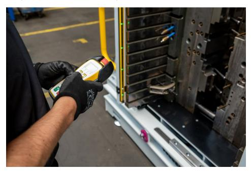
Ein Plus an Arbeitssicherheit und Ergonomie: Über Bediengeräte per Funksteuerung lässt sich der Werkzeugöffner bequem und sicher bedienen (Bild: RUD).
