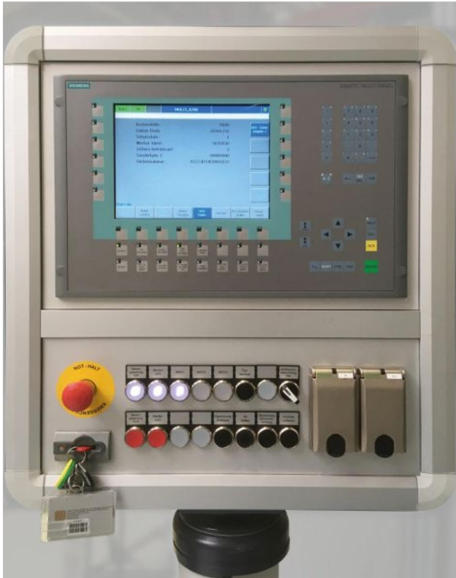
Ist ein Schlüssel gesteckt, liest das System die Zugriffsrechte für die Maschine und die Betriebsarten aus (Bild: Euchner).
