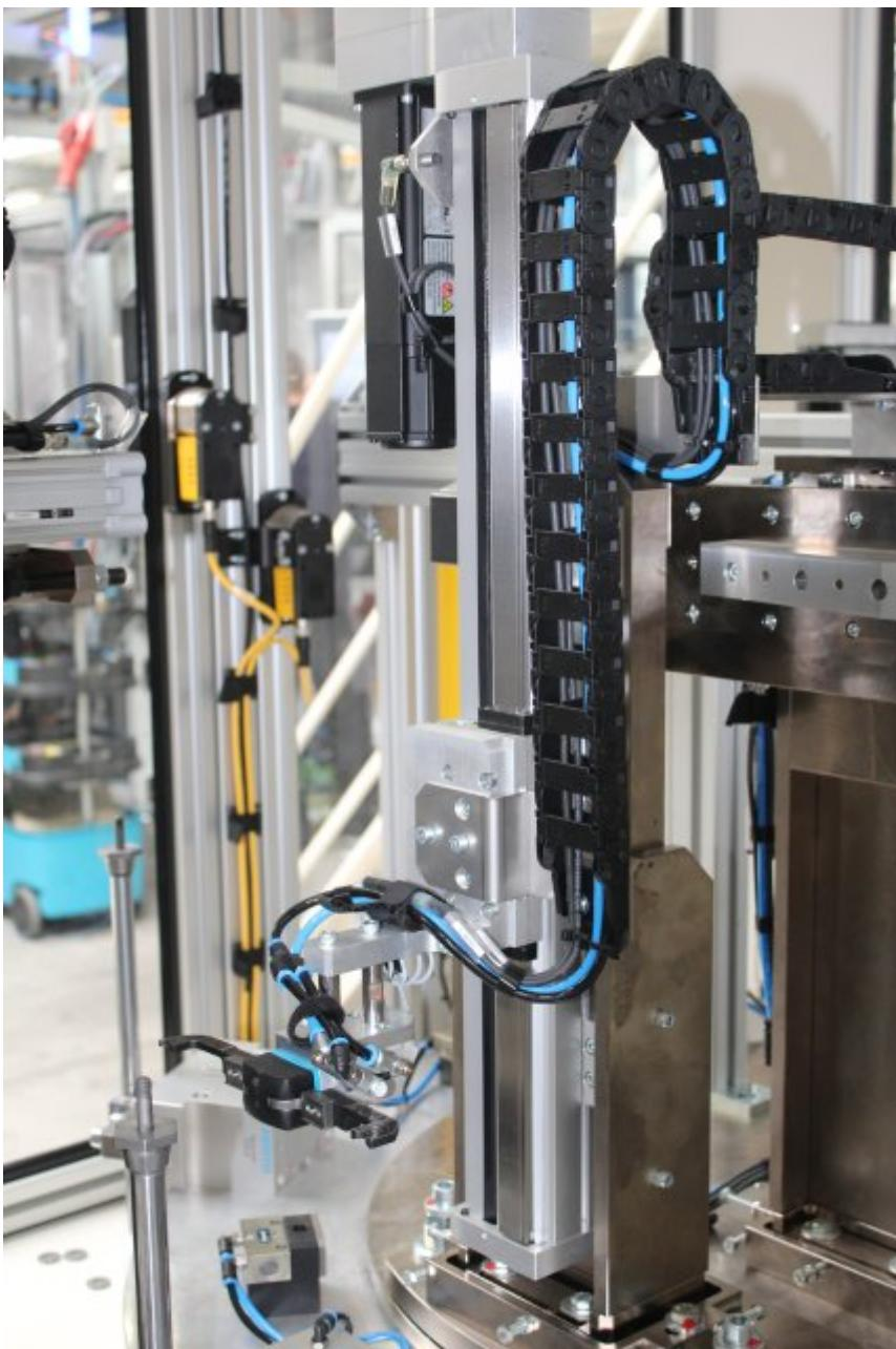
Die Montagezelle wird im Dreischicht-Betrieb Stoßdämpfer im 20-Sekunden-Takt produzieren. Zur Absicherung der fünf Schutztüren kommt ein berührungslos wirkendes Schutztürsystem zum Einsatz (Bild: Pilz).
