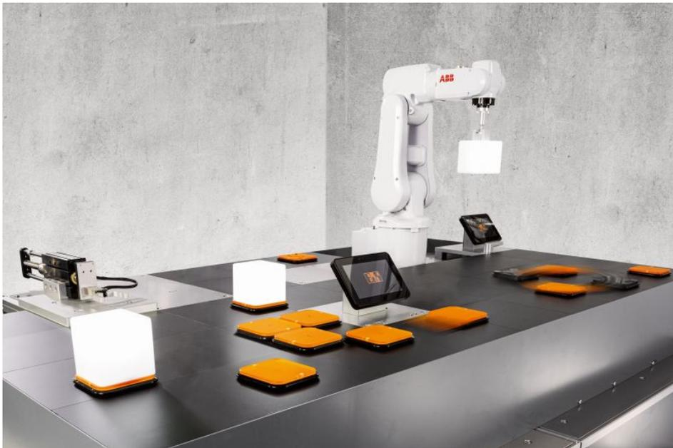
Flexible Transportsysteme können jedes Produkt individuell bewegen und auch als eigenständige Achse bei Bearbeitungsstationen eingesetzt werden (Bild: B&R).
