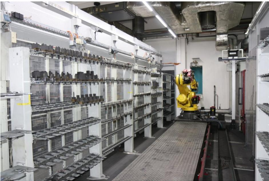
Vier HSC-Fräsmaschinen und eine Koordinatenmessmaschine sind verkettet und an das MES angebunden (Bild: Hummingbird).
