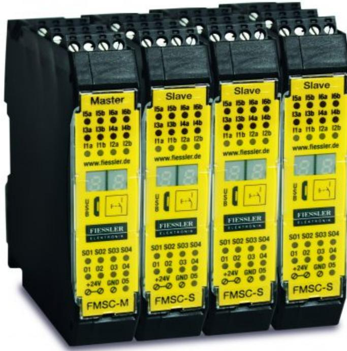
Die Sicherheitssteuerung »FMSC« (Fiessler Modular Safety Controller) von Fiessler Elektronik zeichnet sich durch ein modulares Konzept aus. Somit lässt sich das Steuerungskonzept flexibel an die steuerungstechnische Aufgabe anpassen. Dazu stehen verschiedene Master- als auch Slave-Geräte zur Verfügung. Jedes Steuerungsmodul besitzt 12 Eingänge, vier sichere Ausgänge und fünf
