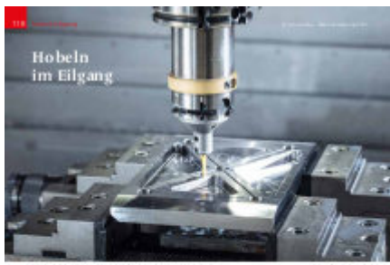
Die neue »Eilgang«-Reihe von Paul Horn ist ein Meilenstein in der Nutenfertigung. Sie ermöglicht die Herstellung von Nuten mit einer Tiefe von bis zu 10 mm und einer Breite von bis zu 10 mm. Die neue »Eilgang«-Reihe von Paul Horn ist ein Meilenstein in der Nutenfertigung. Sie ermöglicht die Herstellung von Nuten mit einer Tiefe von bis zu 10 mm und einer Breite von bis zu 10 mm.
