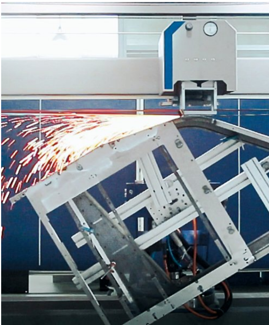
Die neue Schleifmaschine »OG-Twin-3107-AF«. Dank PC-basierter Steuerungstechnik konnte für die Maschine eine optimierte Steuerung entwickelt werden (Bild: PMA Pacific, China).
