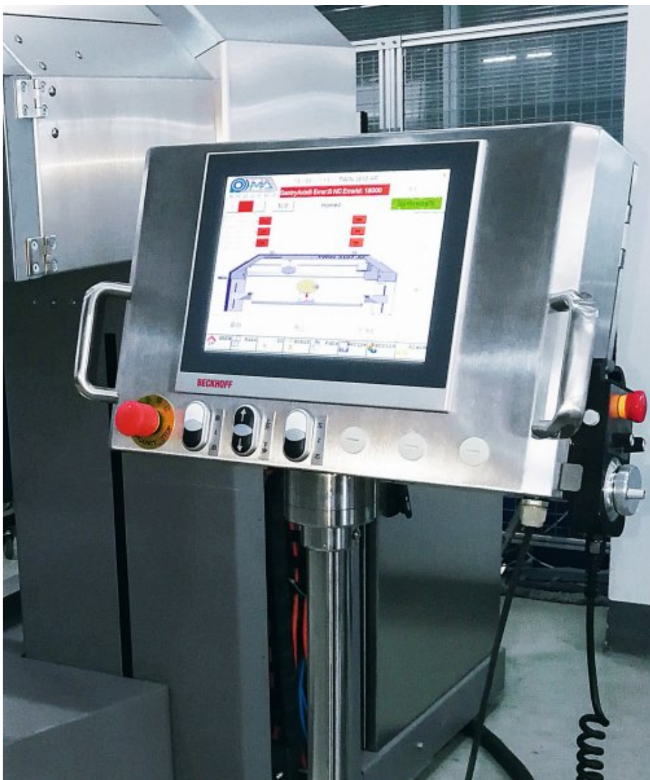
Die Schleifmaschine lässt sich über ein Multitouch-Control-Panel »CP2915« komfortabel bedienen (Bild: PMA Pacific, China).
