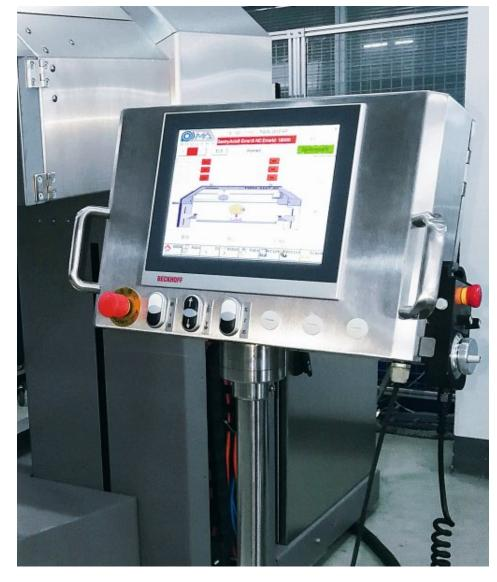
Die Schleifmaschine lässt sich über ein Multitouch-Control-Panel »CP2915« komfortabel bedienen (Bild: PMA Pacific, China).
