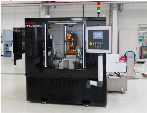
Die neue Superfinish-Schleifmaschine wurde gezielt für die wirtschaftliche Wälzlager-Serienfertigung entwickelt (Bild: Supfina).
