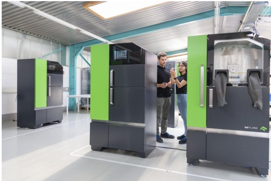
Eine Metall-3D-Drucklösung besteht z. B. aus 3D-Drucker, Auspackstation inkl. Siebeinheit und Datenvorbereitungssoftware (Bild: One Click Metal).
