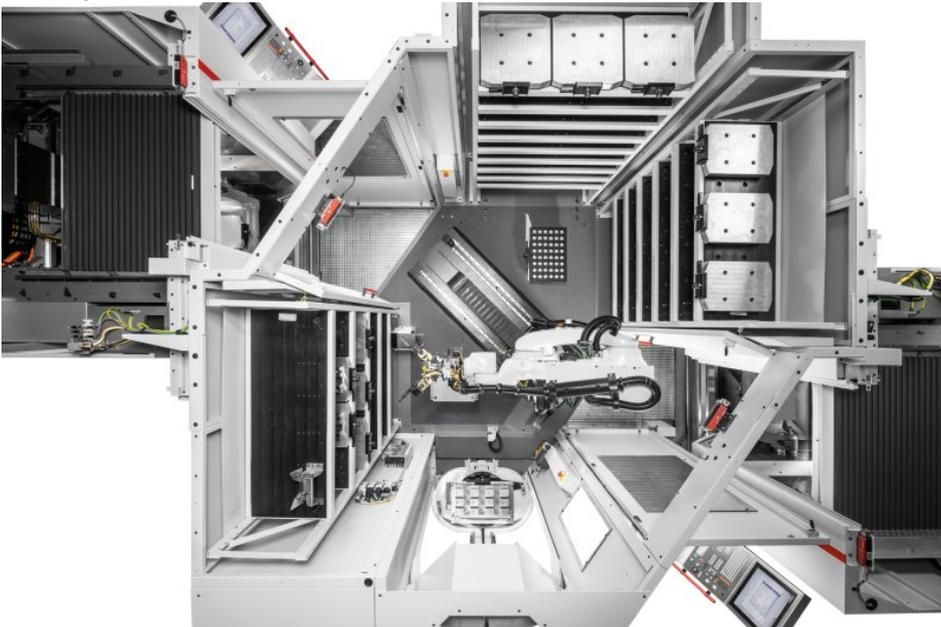
Das neue Robotersystem, adaptiert an zwei Bearbeitungszentren; Speichermodule sorgen für eine lange autonome Laufzeit (Bild: Hermle).
