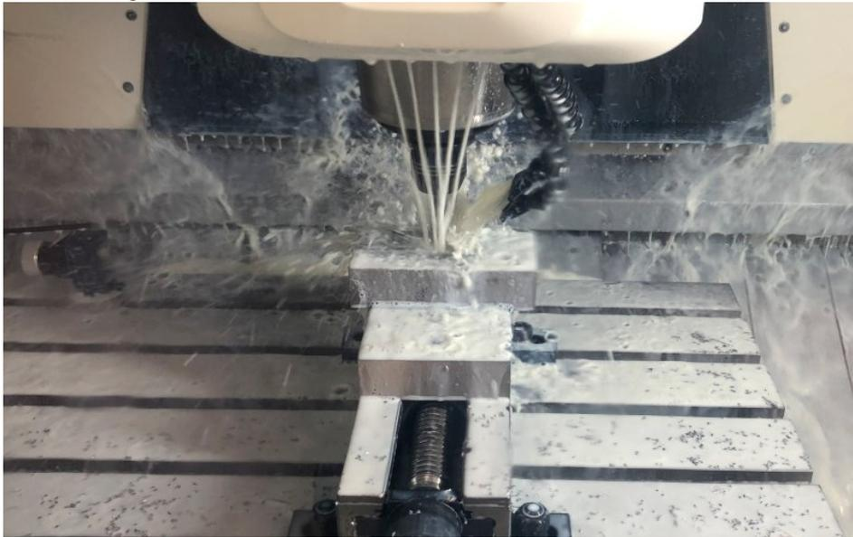
Der neue Kühlschmierstoff wurde auch für schwere Zerspanung von Stählen und Aluminiumlegierungen entwickelt (Bild: oelheld).
