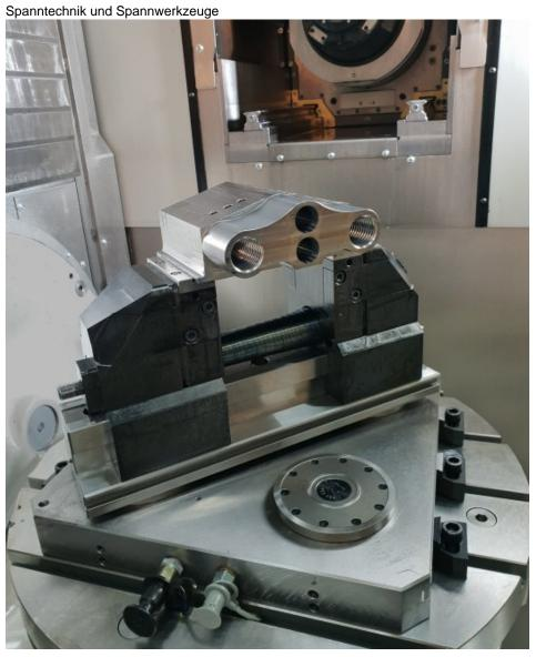
Das Nullpunktspannsystem kann hauptzeitparallel gerüstet werden und verringert so Stillstandzeiten (Bild: Hainbuch).
