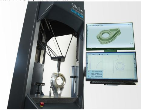
Das CNC-Koordinatenmessgerät kombiniert kompakte Grundfläche mit einfachem Zugang und großem Messvolumen (Bild: Vision Engineering).
