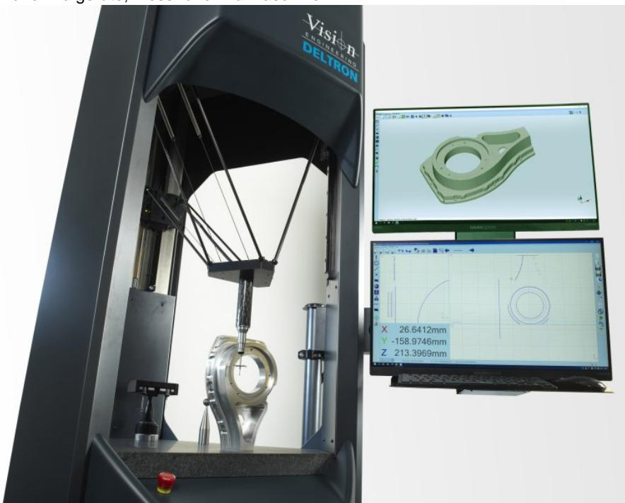
Das CNC-Koordinatenmessgerät kombiniert kompakte Grundfläche mit einfachem Zugang und großem Messvolumen (Bild: Vision Engineering).
