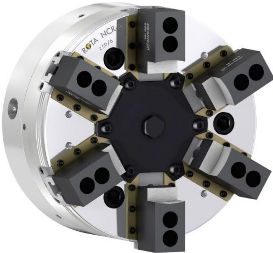
Schunk erweitert sein Programm zur Spannung deformationsempfindlicher Werkstücke um ein abgedichtetes 6-Backen-Pendelausgleichsfutter. Spezielle Dichtungen an der spitzverzahnten Backenschnittstelle und am Kolben verhindern beim »Rota NCR-A«, dass Fett ausgespült wird und die Spannkraft schleichend verloren geht. Auch bei geringen Spannkraften ist eine präzise Funktion des Fatters gewährleistet. Zusätzlich
