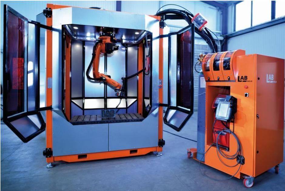
Bei der Schweiß-Kompaktzelle wird durch die Positionierung des Roboters an der Decke die Fläche bestmöglich genutzt (Bild: LAB-weld).
