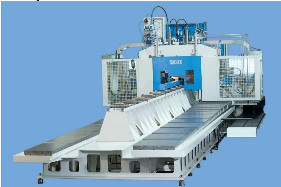
Ein vollautomatisches Bearbeitungszentrum für die flexible Zerspanung unterschiedlicher Profile von bis zu 8 m Länge (Bild: SSB).
