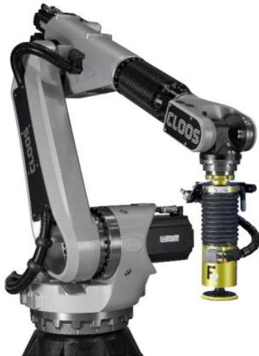
Ein Roboter und sensitive End-Effektoren ermöglichen kundenspezifische automatisierte Schleiflösungen (Bild: Ferrobotics).
