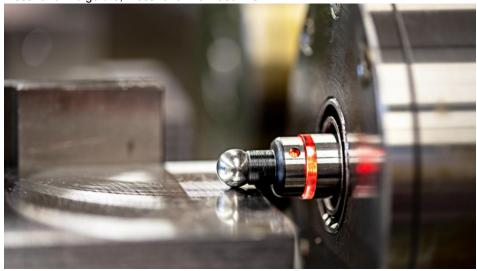
Die Tiefbohrtaster ermöglichen einfaches und präzises Erfassen der Werkstückposition auf Tiefbohrmaschinen (Bild: Tschorn).
