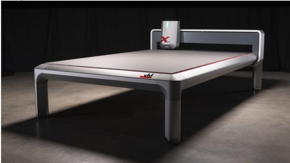
Die Portalfräsmaschine bietet moderne Technik, intuitiven Bedienkomfort und eine 2 x 3 m große Bearbeitungsfläche (Bild: vhf).
