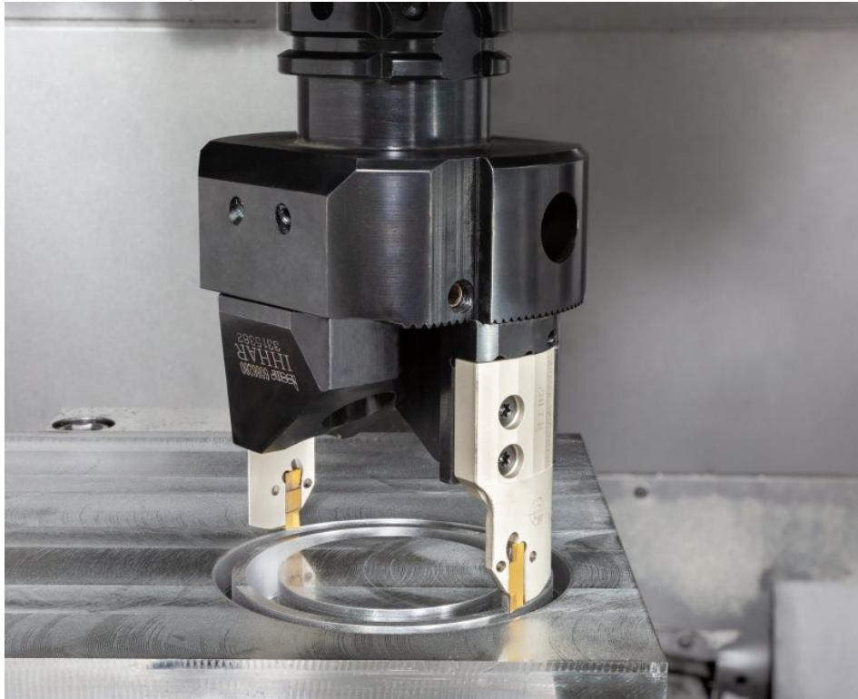
Das neue, einstellbare Bohrkronensystem für axiale Einstiche und Kernbohrungen ist modular aufgebaut (Bild: Iscar).
