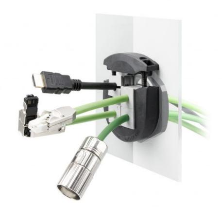
icotek bietet mit der neuen »KVT-ER«-Baureihe eine neue teilbare Kabelverschraubung an. Die robuste Kabelverschraubung dient zur Einführung von Leitungen mit und ohne Stecker. Die Kabelverschraubung setzt auf genormte Ausbrüche in den metrischen Standardgrößen M32, M50 und M63 auf. Sie erfüllt die IP-Schutzarten IP65, IP66, IP67 und IP68 und ist nach DIN EN 60529:2014 zertifiziert. Die hohen Schutzklassen werden durch einen hohen Pressdruck sowie eine integrierte Dichtung ermöglicht. Der
