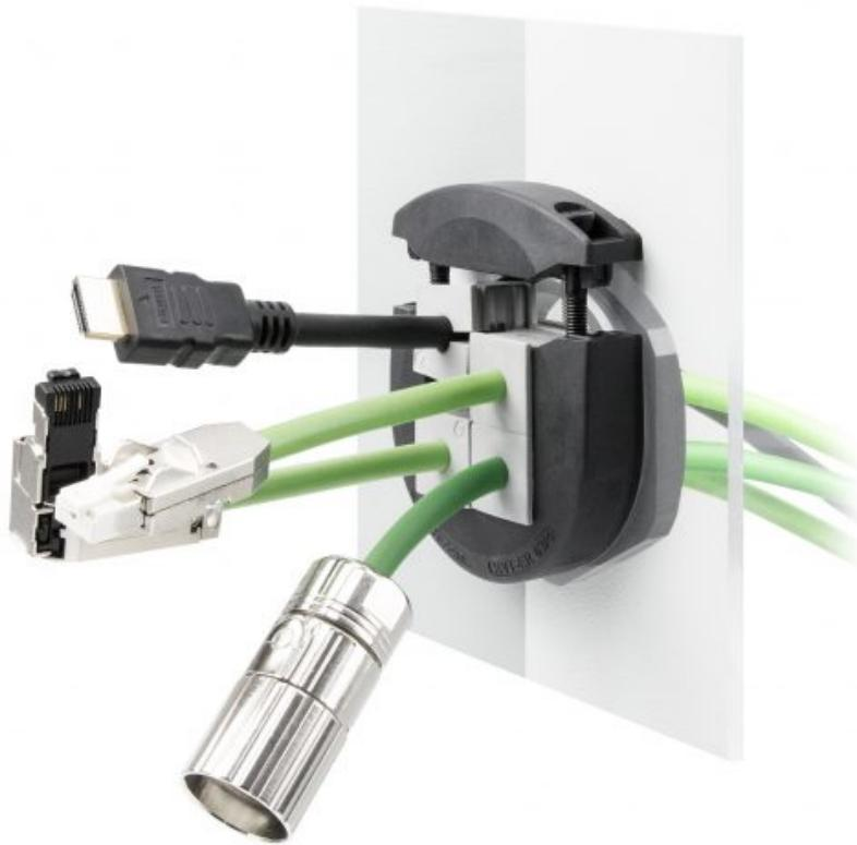
icotek bietet mit der neuen »KVT-ER«-Baureihe eine neue teilbare Kabelverschraubung an. Die robuste Kabelverschraubung dient zur Einführung von Leitungen mit und ohne Stecker. Die Kabelverschraubung setzt auf genormte Ausbrüche in den metrischen Standardgrößen M32, M50 und M63 auf. Sie erfüllt die IP-Schutzarten IP65, IP66, IP67 und IP68 und ist nach DIN EN 60529:2014 zertifiziert. Die hohen Schutzklassen werden durch einen hohen Pressdruck sowie eine integrierte Dichtung ermöglicht. Der
