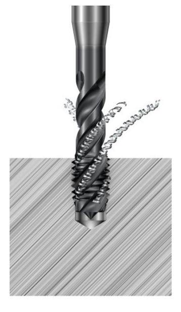
Der spiralgenutete Gewindebohrer für Bohrungen, bei denen die Späne nach hinten transportiert werden (Bild: Sandvik Coromant).
