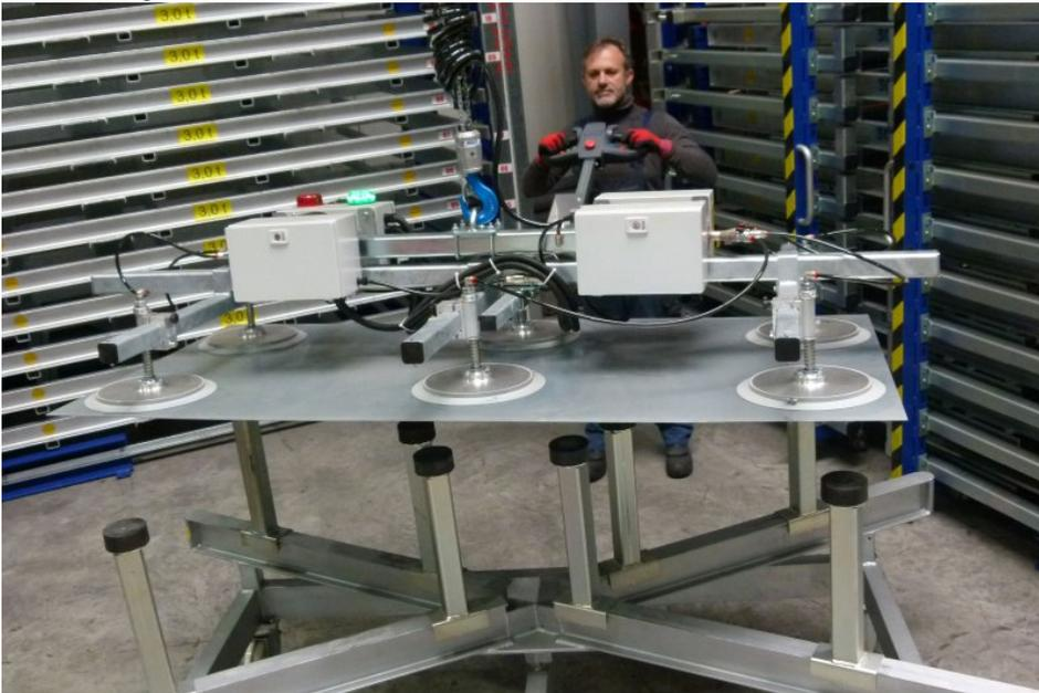
Entnahme einer Metallplatte aus dem Schubladenblechregal und Ablegen auf dem Abstellbock (Bild: Eurotech).
