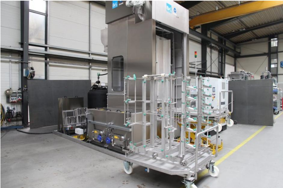
Drehtelleranlage mit speziellem Warenträger, der die Karosserieteile exakt auf die zu reinigenden Stellen positioniert (Bild: BvL).
