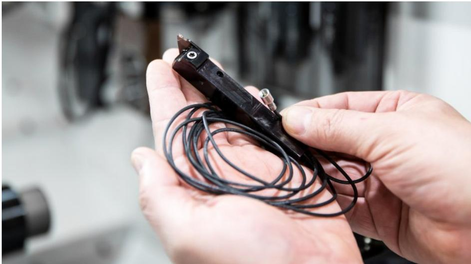
Werkzeugüberwachung von Horn und Kistler: Der Werkzeughalter gibt Informationen über den Zustand des Werkzeugs während des Bearbeitungsprozesses weiter (Bild: Horn).
