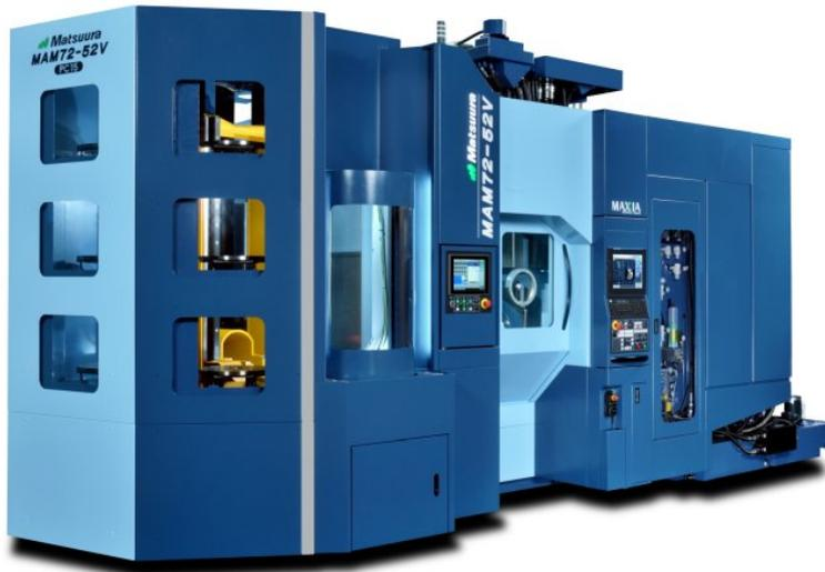
Das neue 5-Achs-Bearbeitungszentrum wurde speziell für den mannlosen Betrieb entwickelt (Bild: Matsuura).
