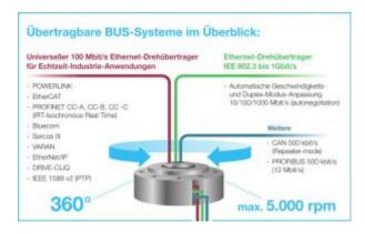
Der universelle Ethernet-Drehübertrager unterstützt nahezu alle Busprotokolle basierend auf IEEE802.3, wie zum Beispiel Profinet IRT, Sercos III, Ethercat, Ethernet/IP und Powerlink. Bild: Spinner
