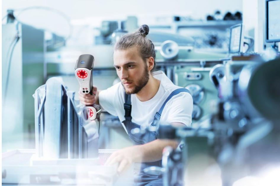
Der flexible und präzise handgeführte Laserscanner erfasst Messdaten in Produktionsumgebungen (Bild: GOM).
