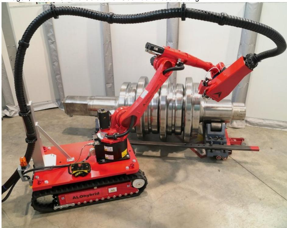
Anwendungsbeispiel Laserhärtung einer Welle mithilfe der mobilen Laseranlage (Bild: Alotec Dresden).
