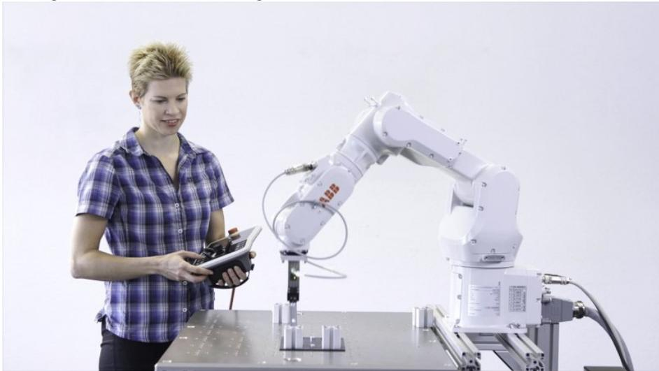
Die Roboterprogrammierung erfolgt einfach vor Ort mit dem abgesetzten Bedienteil (Bild: ABB).
