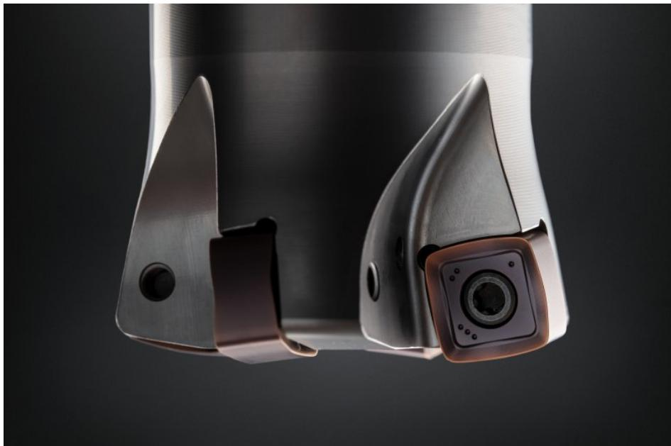
Die positive Schneidengeometrie sorgt bei Wendeschneidplatten trotz der negativen Einbaulage für einen weichen und ruhigen Schnitt (Bild: Horn/Sauermann).
