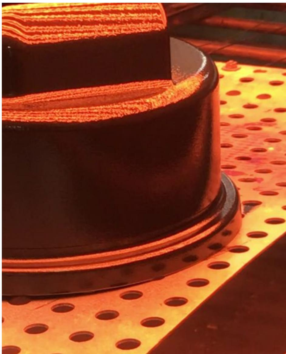
Beim Pulver-in-Pulver-Verfahren wird das Grundierungspulver aufgebracht, direkt danach durch Infrarot-Wärme aufgeschmolzen und dann das Decklackpulver bereits aufgetragen (Bild: Heraeus Noblelight).
