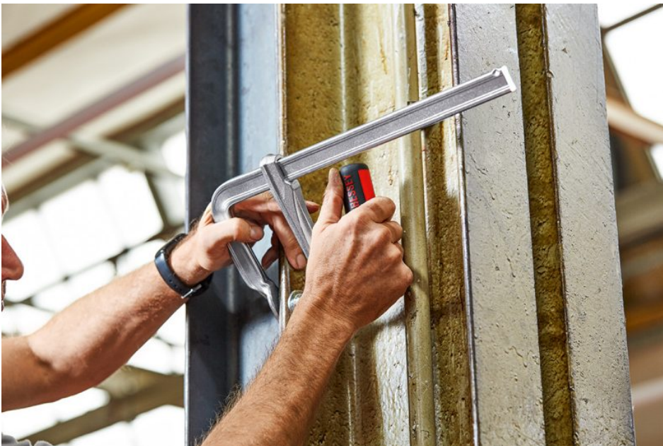
Der Griff lässt sich an schwer zugänglichen Stellen einfach wegklappen (Bild: Bessey).
