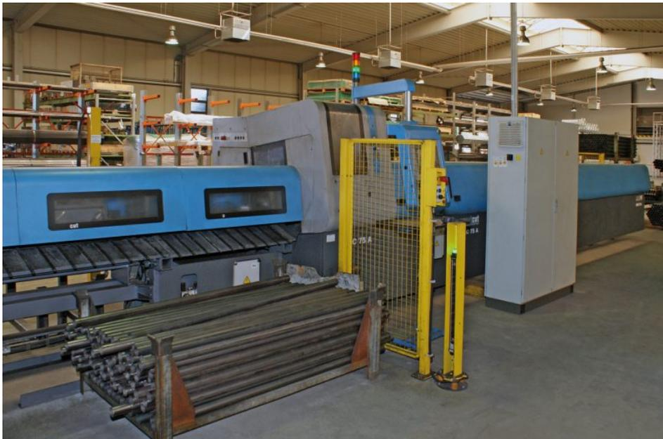
Die automatisierte Hochleistungskreissäge, Blick auf den Materialauswurf der abgetrennten Teile (Bild: give4pr).
