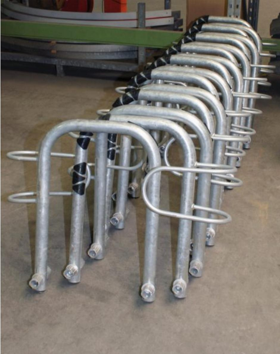
Diese Rohrbügel werden auf der Hochleistungssäge und dem Bohrautomaten bearbeitet (Bild: give4pr).
