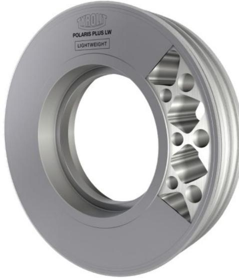
Schleifwerkzeuge mit Leichtbau-Trägerkörper sind spindel- und lagerschonender als vergleichbare Produkte ohne Leichtbau-Trägerkörper (Bild: Tyrolit).
