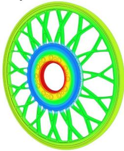
Mittels FEM-Simulation werden Schleifwerkzeuge mit »LW«-Technologie bestmöglich ausgelegt – bei gleichzeitig höchstmöglicher Gewichtsreduktion (Bild: Tyrolit).
