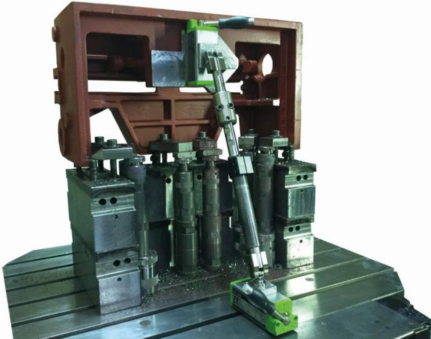
Durch seine unterschiedlichen Befestigungsvarianten am Werkstück und am Maschinentisch bietet der Werkstückstabilisator eine besonders hohe Flexibilität (Bild: Kipp).
