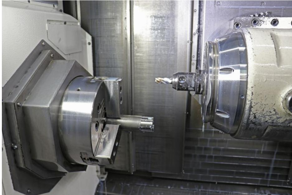
Im halbjährigen Feldtest wurde die neue Fräsergeneration auf verschiedenen Bearbeitungszentren getestet: 20 bis 40 Prozent höhere Schnittwerte und parallel dazu um 30 bis 40 Prozent längere Standzeiten waren das Ergebnis (Bild: Ceratizit).
