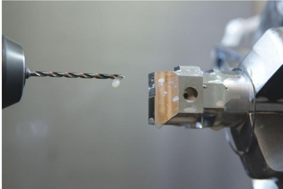
Zum Bohren tiefer und schlanker Bohrungen stehen im Standardwerkzeugportfolio spiralierte VHM-Tieflochbohrer zur Verfügung (Bild: Walter).
