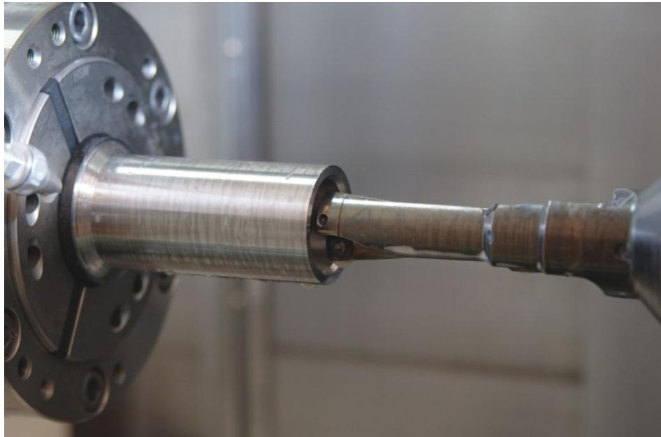
Für die Bearbeitung der Hauptzylinderbohrung wurde ein Sonderwerkzeug entwickelt. Dies war Teil des neuen Fertigungskonzepts für die Teile aus Edelstahl (Bild: Walter).
