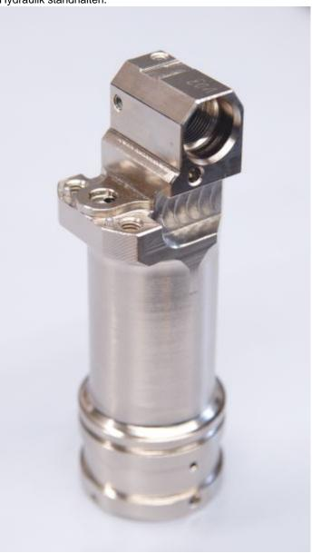
Komplex: Wegen der umfassenden Funktionsintegration sind die kompakten und leichten Antriebszylinder aus hochfestem Stahl umfassend rundum zu bearbeiten (Bild: Walter).
