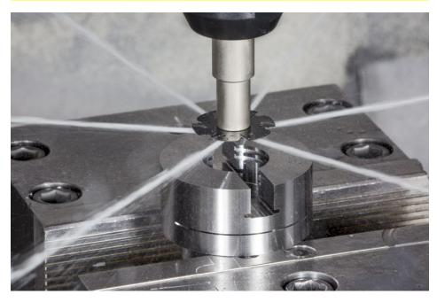
Die innere Kühlmittelzufuhr des Schlitzfräsers wirkt direkt in der Schnittzone und ermöglicht so lange Standzeiten (Bild: Iscar).
