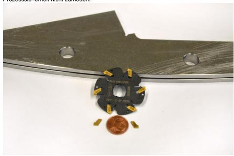
Mit Schneidenbreiten von 0,8 bis 1,2 Millimetern ist der Fräser einer der schmalsten Schlitzfräser auf dem Markt. Heidelberger Druckmaschinen bearbeitet damit rund 400 Edelstahlkomponenten pro Monat in gleichbleibend hoher Qualität (Bild: Iscar).
