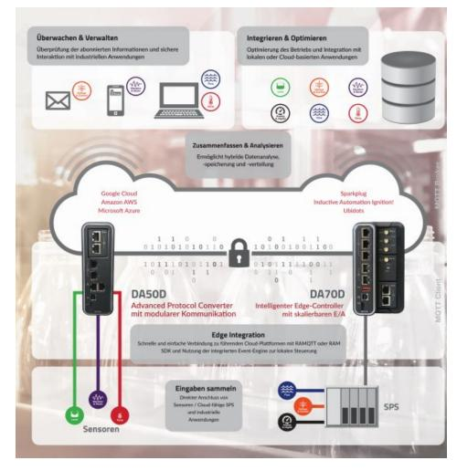
Mit einer modularen Edge-Automationsplattform werden Maschinen und Anlagen Schritt für Schritt fit für die IIoT-Integration gemacht (Bild: Red Lion Controls).
