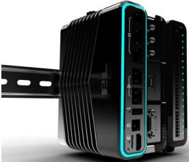
Intelligenter Edge-Controller (links) mit drei gesteckten Sleds (mitte) und I/O-Steuermodul (rechts; Bild: Red Lion).
