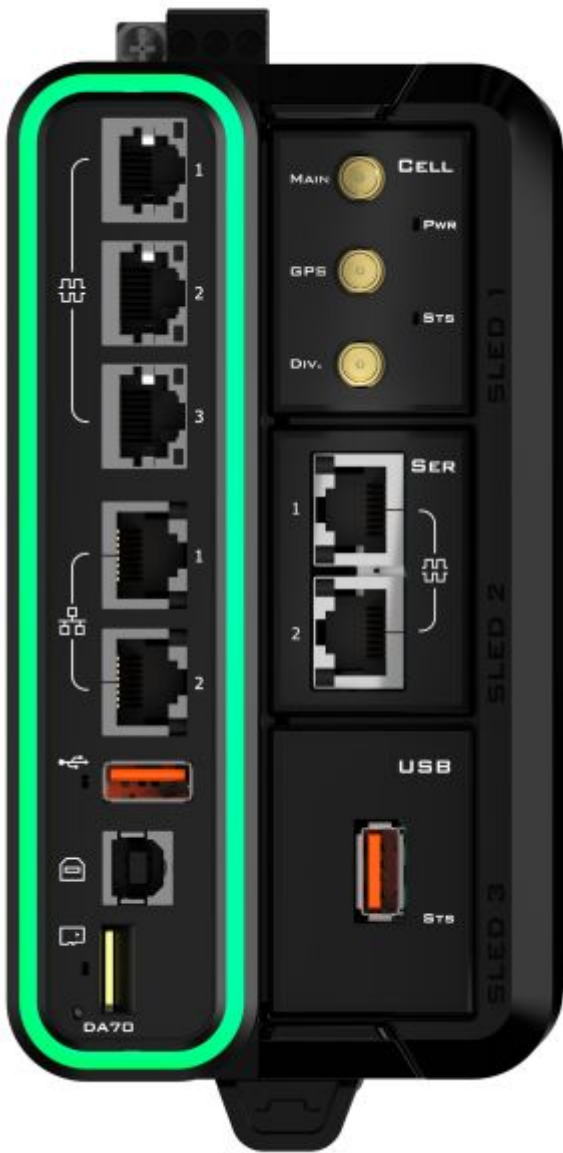
Frontansicht des Edge-Controllers (Bild: Red Lion).
