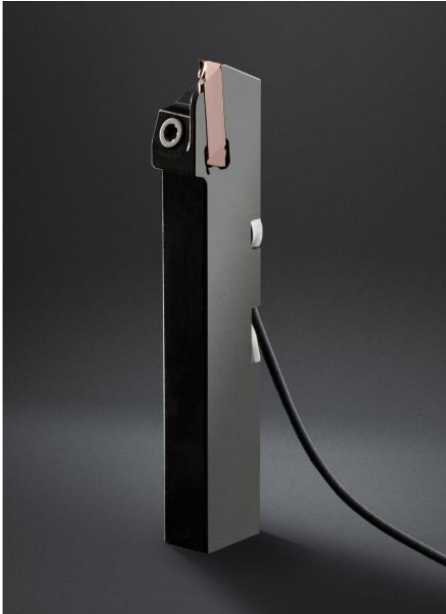
Kombination von Werkzeug und Sensor als innovative Echtzeit-Werkzeugüberwachung bei Mikro-Drehbearbeitungen (Bild: Horn/Sauermann).
