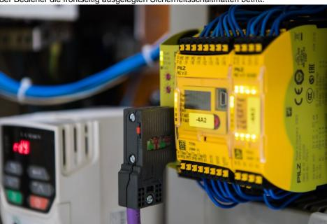
Die sichere konfigurierbare Kleinsteuerung mit je einem Kommunikations- und Erweiterungsmodul (Bild: Pilz).
