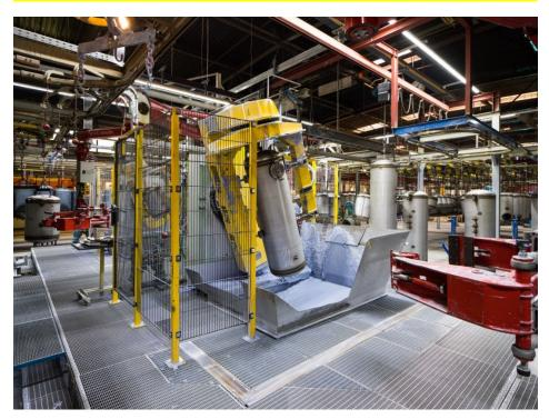
Der Bereich um den Einzelpositionierer ist von drei Seiten zugänglich. Im Hintergrund wird ein Behälter zugeführt. Nach erfolgter Bearbeitung übernimmt ein Greifer (rot) den Behälter (Bild: Pilz).
